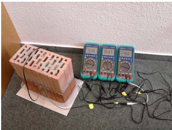
Abb. 4-1 Messaufbau Test „kleines Mauerwerk“
